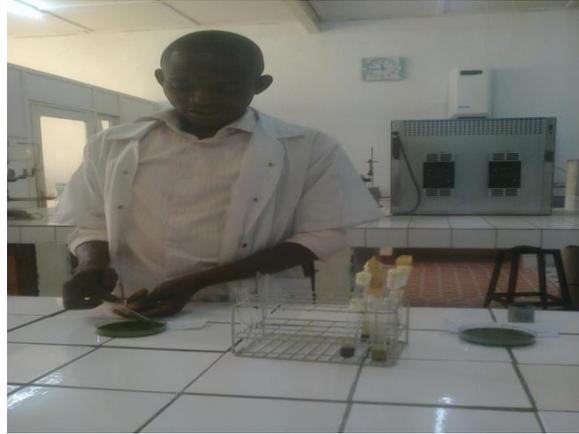
**Figure 13 :** Préparation des extraits bruts aqueux et la mise dans les tubes à essai des extraits bruts aqueux pour les concentrer à l'étuve.
