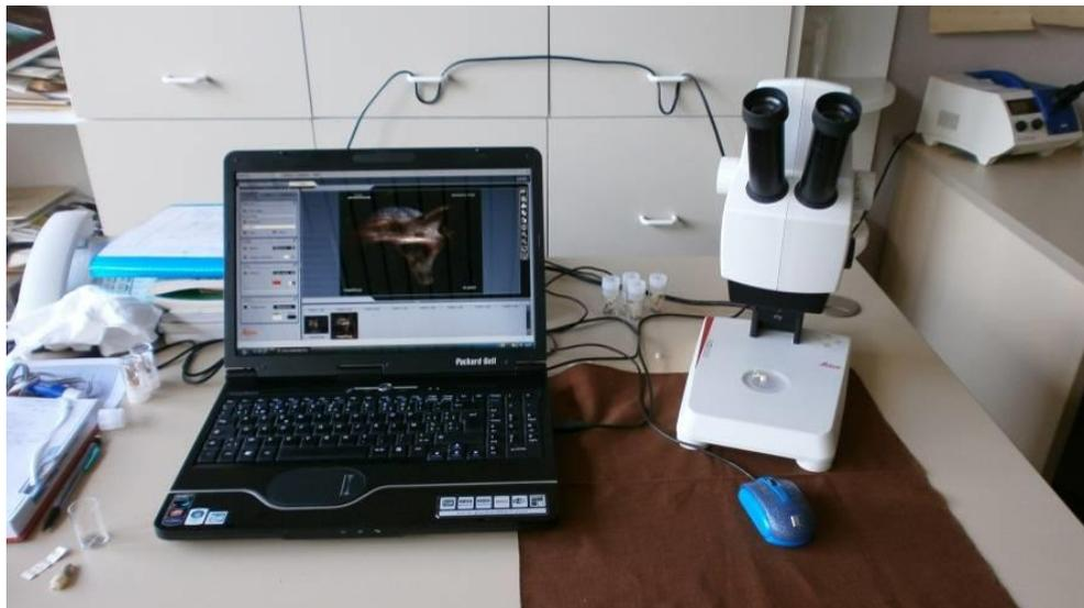
Fig. (1) Prise des images sous la loupe binoculaire Leica EZ4D LAS EZ 1.7.0
