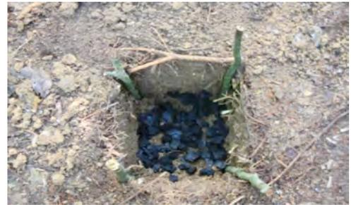
Fig. 5. Dispositif expérimental : a) charbons tamisés à 4mm, b) mise en place des sondages, c) première couche de charbons à 60 cm et d) deuxième couche de charbons à 20 cm.
