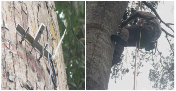
Fig. 1. links: dendrometer op *Terminalia supera*; rechts: installatie camera voor fenologische observaties.
