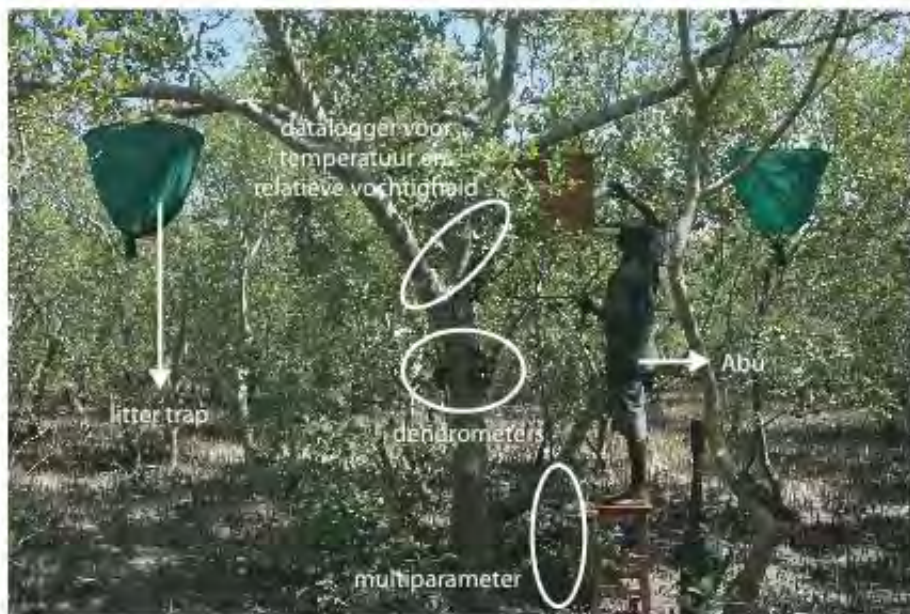
Figuur 1: Dendrometerinstallatie in het mangrovebos van Gazi Bay, Kenia.
