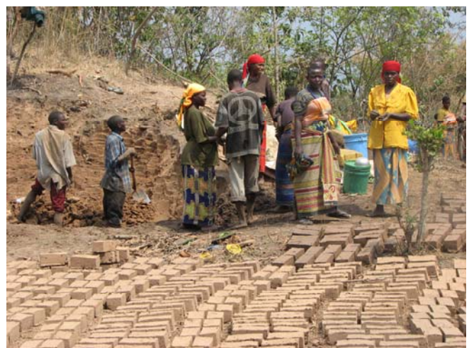
Fig. 15 : Le sol des hautes termitières est utilisé dans la fabrication des briques à Kayogoro
