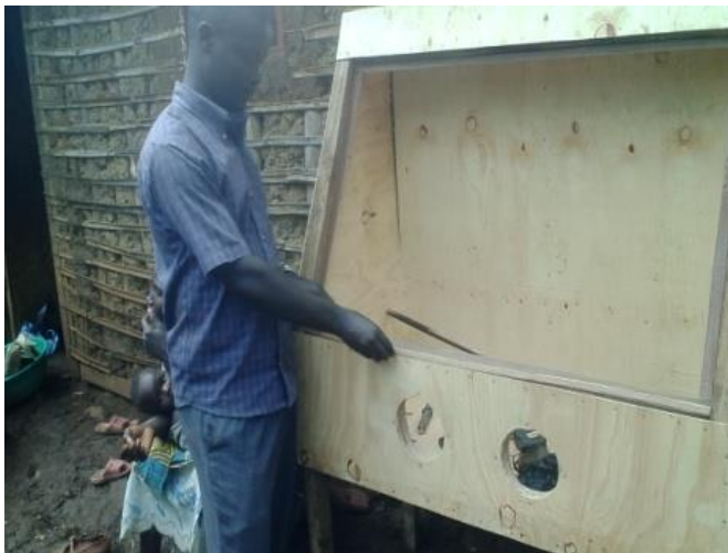
Fabrication locale d'une boîte d'inoculation
