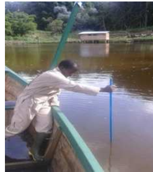
Mesure de la transparence de l'eau pour évaluer l'état de fertilité
