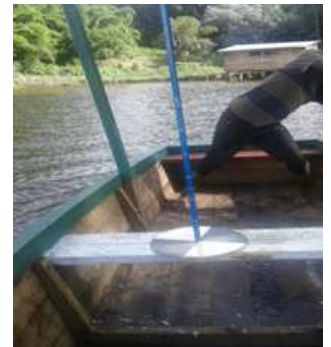
Disque de Secchi graduée jusqu'à 60 Cm
