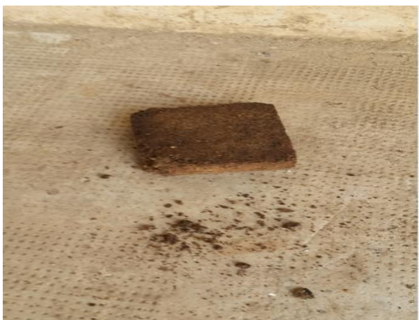
Figure 2. Etat de la briquette après la chute libre
