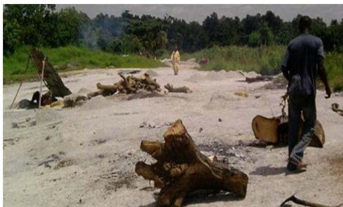
**Photo 4:** Exploitation du granite avec des troncs d'arbre pour chauffer la pierre
